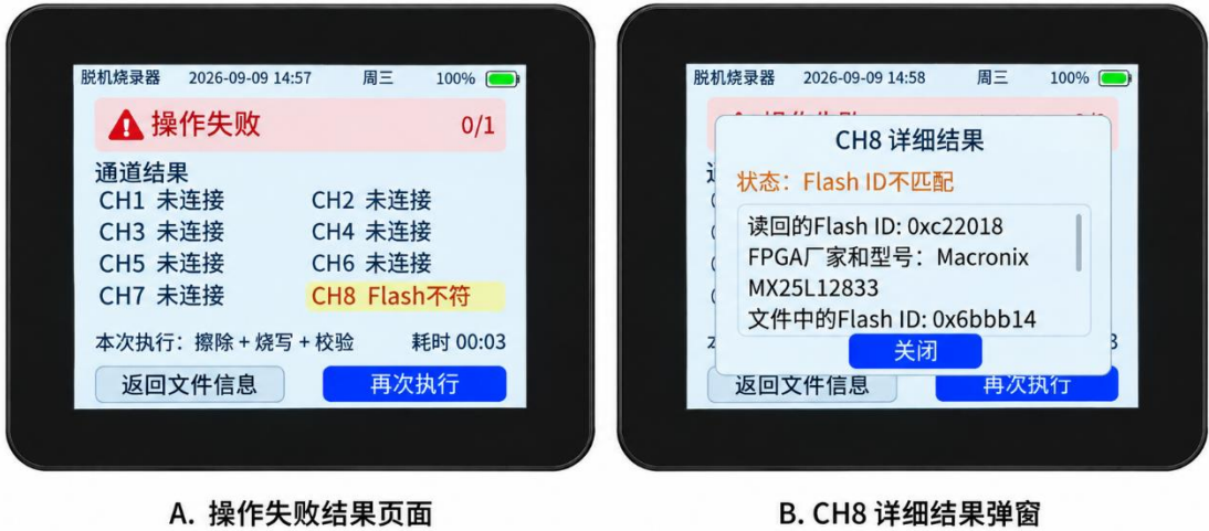
图 3-24 器件不匹配及通道详细信息（点击 A 显示界面的“CH8 Flash 不符”可看到 B 页面显示的具体信息）
