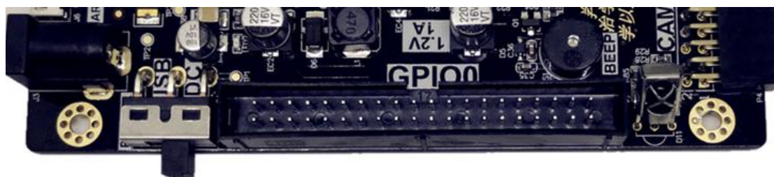
图 2-4 GPIO0 和 Cyclone IV E FPGA 连接示例
