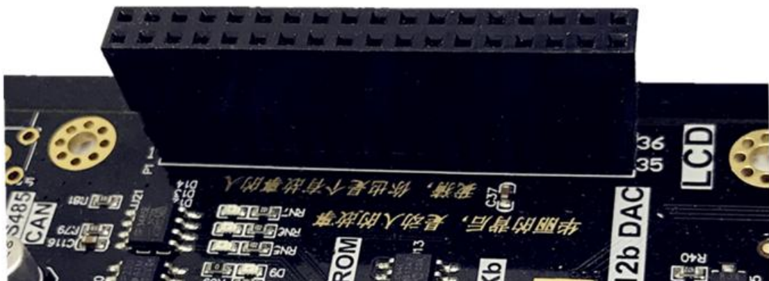
图 2-9 通用显示扩展接口与 FPGA 连接
