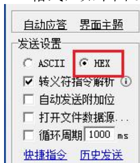
图 65-28 设置发送格式为 hex 码格式
